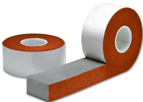
Cinta de espuma de poliuretano precomprimida, impregnada en una resina sintética que asegura la estanqueidad al aire y la lluvia y, a su vez, es permeable al vapor de agua. Resiste a los rayos UV. Disponible en una gran variedad de formatos.
