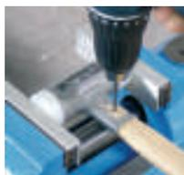
5. Utilizar una broca de 3,8mm de diam. para perforar el nuevo mango a través del agujero del cuerpo metálico.
