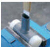
4. Colocar el mango de repuesto completo con la cuña de aluminio incluida dentro del cuerpo metálico y presionar / golpear el mango hasta dentro.
