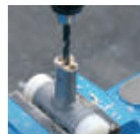
3. Retitar completamente el resto de mazo de madera del cuerpo metálico con la ayuda de un taladro.
