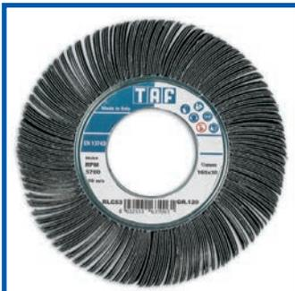
Cepillos en carburo de silicio que vienen empleados en máquinas portátiles para el desbaste y acabado del mármol y piedra. El montaje sobre el eje de la máquina se hace mediante una pareja de bridas de reducción.
