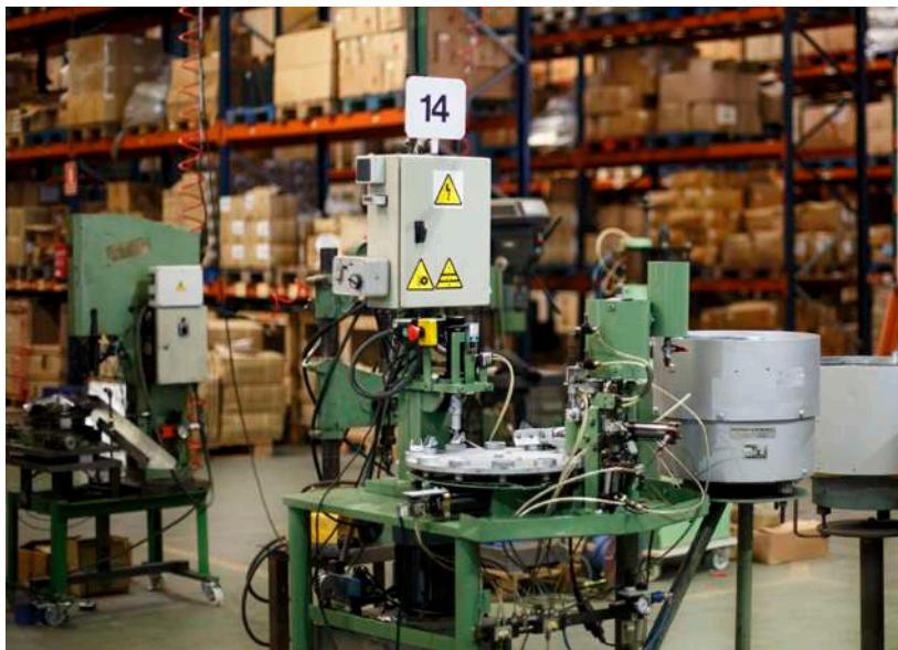
Disponemos igualmente de maquinaria automatizada para realizar el ensamblaje de los soportes a partir de todos sus componentes que se han fabricado anteriormente.
